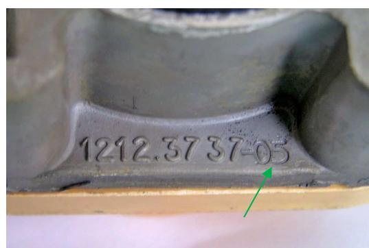
Вид выключателя. В подделке – маркирован как 1212.3737-04, в оригинальном выключателе – 1212.3737-05.
